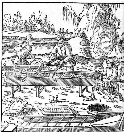
2. ábra. Agricola: De re metallica , 172. sz. Aranyérc mosása teknőben és rekeszes vályúban című metszete.
